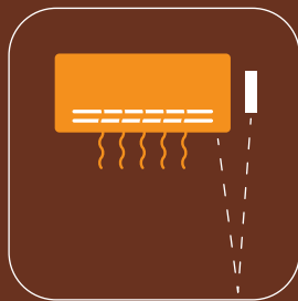
Figur 2 Fastgjort til højre side af den indendørs enhed
